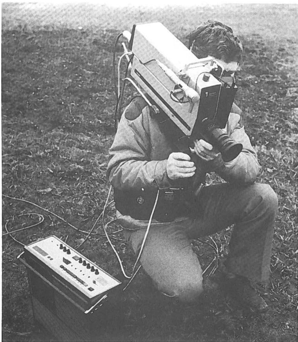
Draagbare Philips televisieopname eenheid „Plumbicon“-camerabuis.
